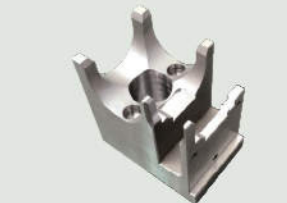
NCフライス プログラムを組み、コンピューター制御によって高精度を要するフライス加工が可能です。数量が多く均一性が重視される製品に使用されます。
